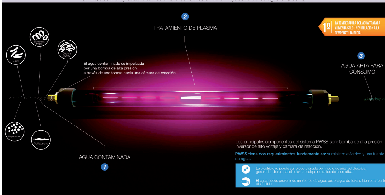
Plasma Water Sanitation System : Infografía Sistema de sanitización de agua por plasma, desarrollado por el Centro de Innovación Avanzada AIC
