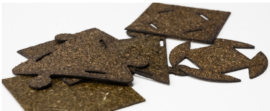
FIG 6. Pruebas de corte y grabado láser CNC. Elaboración propia.
