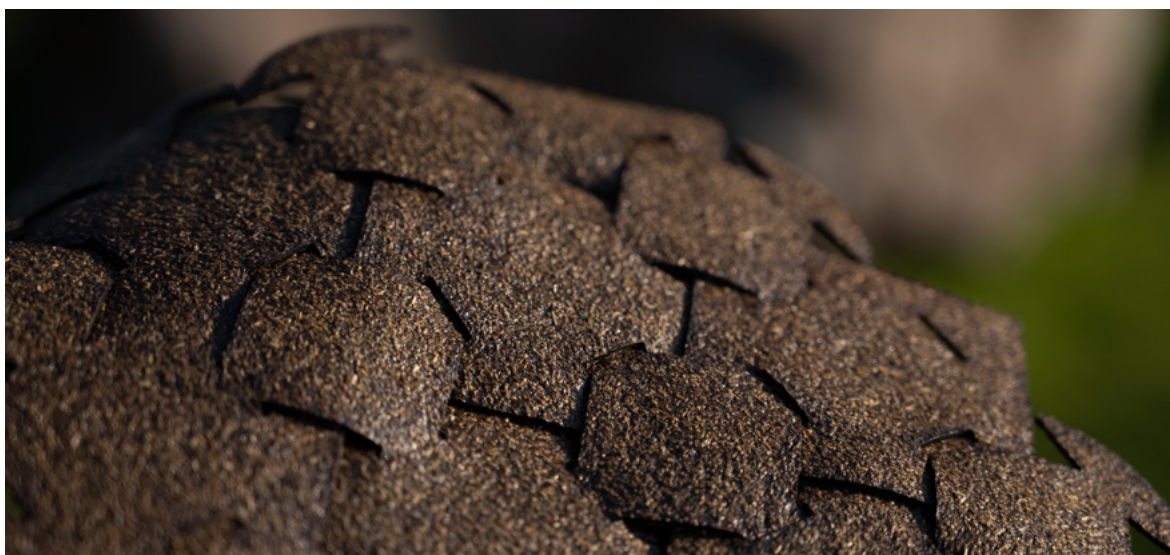
FIG 8. Enlace de módulos con corte láser del material: Elaboración propia. FIG 8. Link of modules with laser cutting of the material: Own elaboration.
